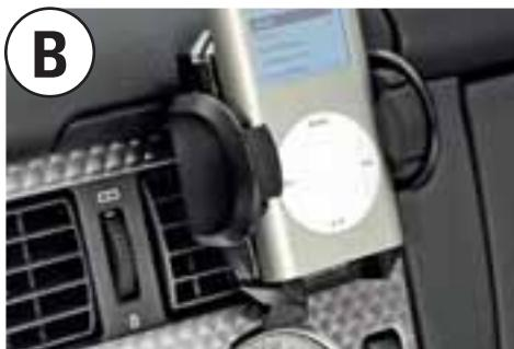
**B** Der Halter für Lüftungsgitter wird auf die geöffneten Lamellen aufgeschoben bis er einrastet.
