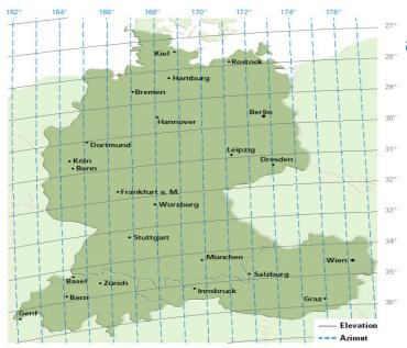
Beispiel | Satellit | Astra am Standort | Würzburg | Azimut (Kompaß) | 167,99° Elevation (Winkel) | 32,29°
