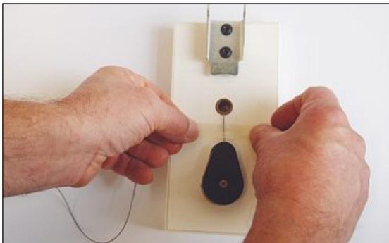
**WICHTIG:** Stahlseil mit einem starken Klebeband o. Ä. auf der Rück- sowie Vorderseite fixieren, damit es bei den folgenden Steps nicht eingezogen wird und in dem Gehäuse verschwindet.
