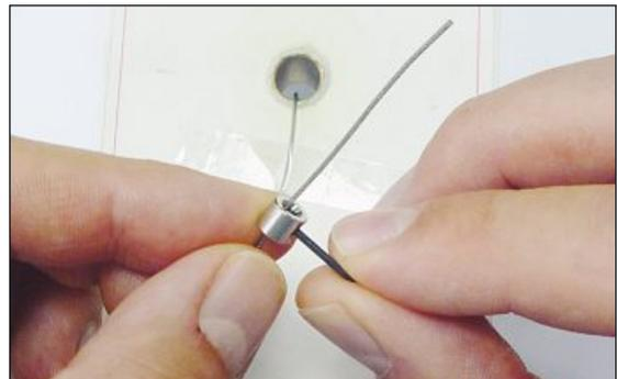
Die Buchse mit dem Imbusschlüssel lockern.
