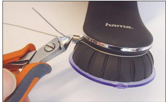
Mit dem Imbusschlüssel die Buchse wieder festziehen und das überflüssige Seilstück mit einem Seitenschneider abknipsen.
