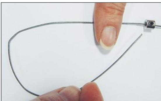
Mit dem Stahlseil eine Schlaufe bilden und das Schlaufenende in die Buchse stecken.
